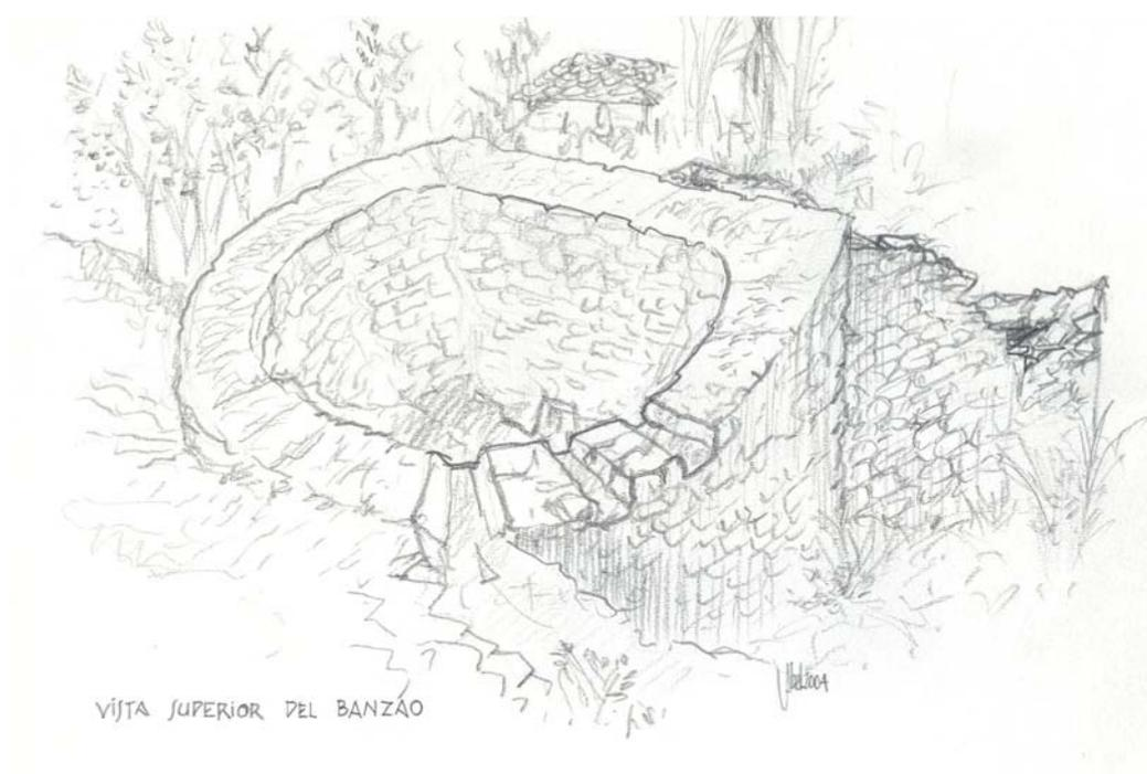
En el croquis de la derecha se aprecia la salida de agua del banzao hacia el molino -o siplo-. La embocadura tiene forma abocinada y partiendo del fondo del depósito se dirige hacia el rodete, rodezno ó "turbina" hidráulica que puede ser de madera -las mas antiguas- ó metal.
